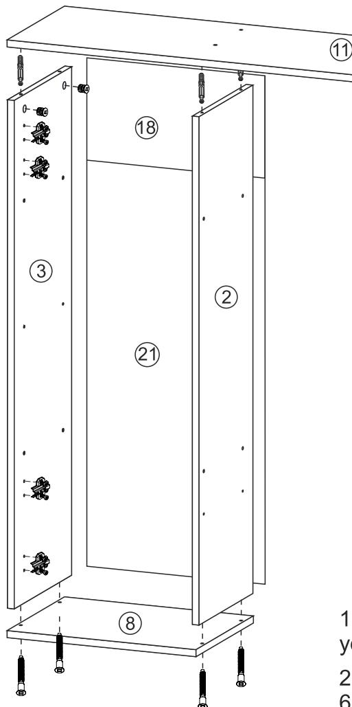
Монтаж эксцентриковой стяжки
